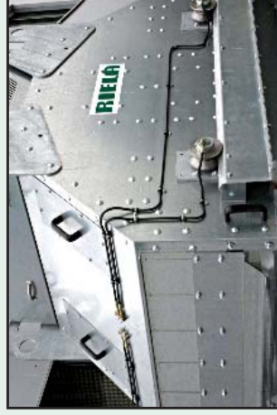
Centralny układ smarowniczy dla wózka mieszającego
