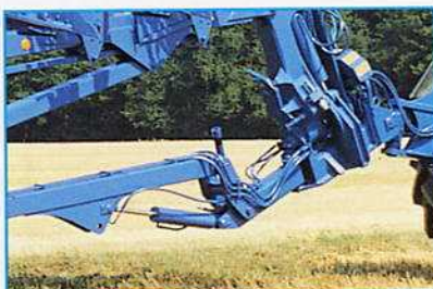
Kombinowany siłownik do zespołu obracania ramy i zmiany szerokości roboczej pierwszego korpusu
