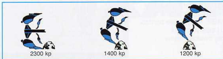
Spadek siły cofania wraz ze wzrostem unoszenia korpusu
